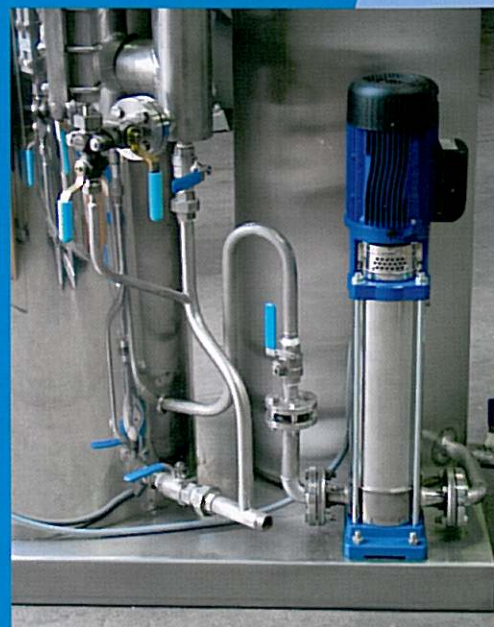
2 - particolare pompa in acciaio inox/stainless steel pump unit
