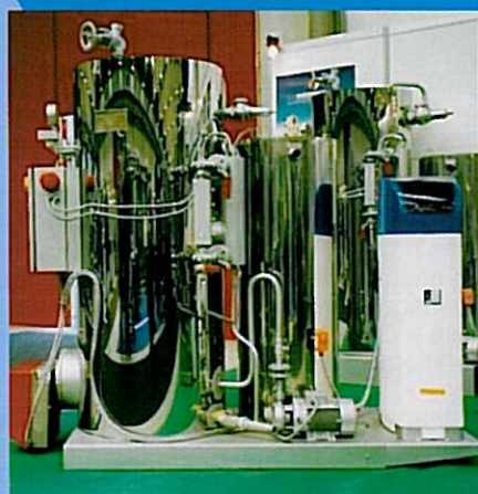
4-Serbatoio chiuso in acciaio inox completo di sonde di livello, elettrovalvola ed addolcitore automatico completo di filtro e base prolungata (tutto a richiesta).
