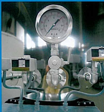
1-Gruppo pressostati con 2 pressostati di regolazione (per bruciatore a due fiamme o modulante), pressostato di sicurezza a riarmo manuale, rubinetto prova pressione, manometro, (2° pressostato di regolazione a richiesta fino alla GVR 300).
