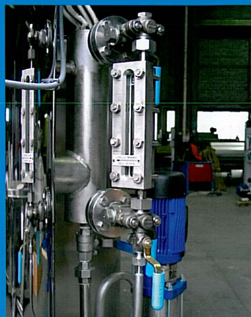
1 - particolare gruppo di livello in acciaio inox / stainless steel level unit
