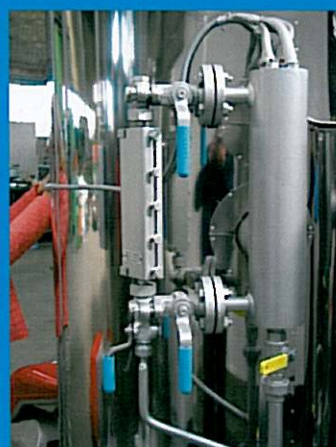
5-Gruppo livello con 2 sonde di livello e 2 di sicurezza (di serie).
