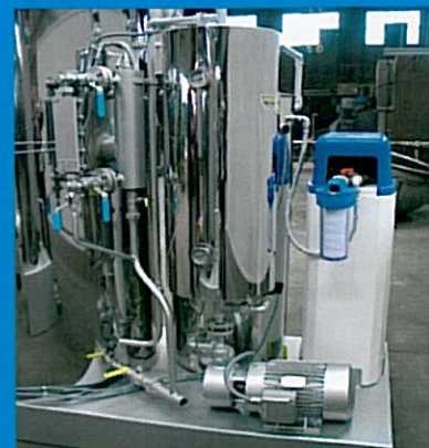
9-Condensate system 3: nuovissimo sistema che invia direttamente le condense in caldaia senza passare per la pompa, recuperando così tutta l'energia, eliminando definitivamente il problema della cavitazione pompa e delle fumane.
